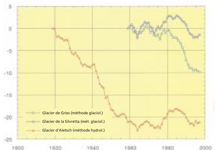
Figure 2 Variations annuelles cumu- lées (en m) des bilans de masse des glaciers d'Aletsch, de Gries et de la Silvretta
