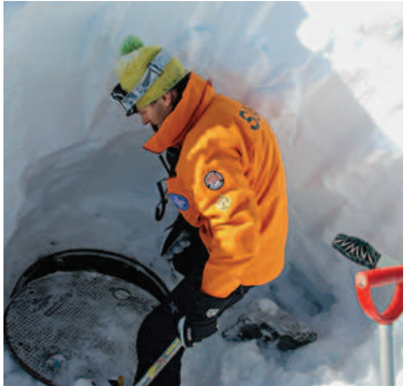
Les données du forage dans le pergélisol au col de la Flüela doivent entre-temps être effectuées en hiver, car il s'y produit trop de chutes de pierres en été. Photo: Marcia Phillips, SLF Davos
